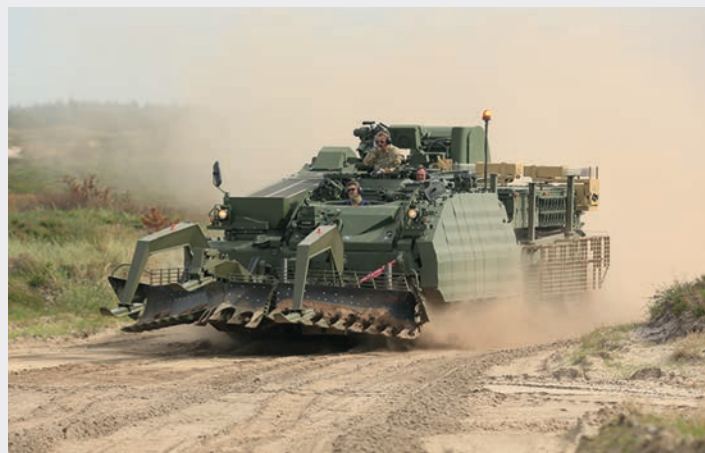
Kanadischer PiPz WiSENT 2 mit Schutz- und Minenräumausrüstung
