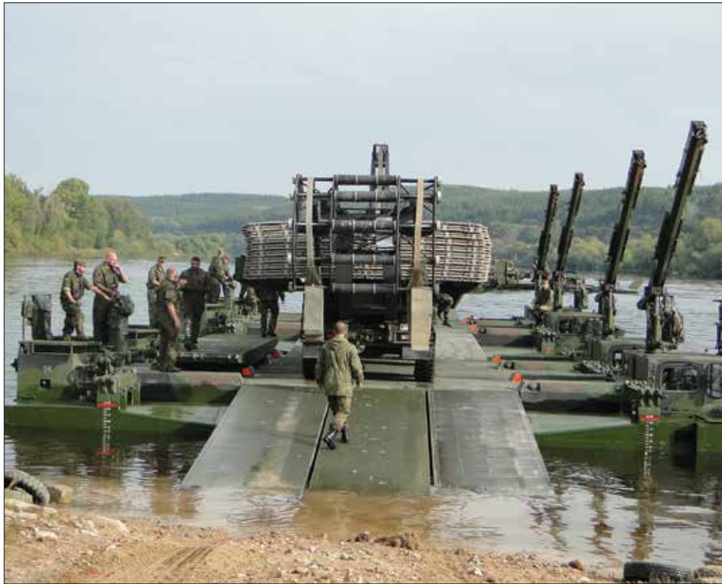
Ein Faltstraßengerät wird übergesetzt
