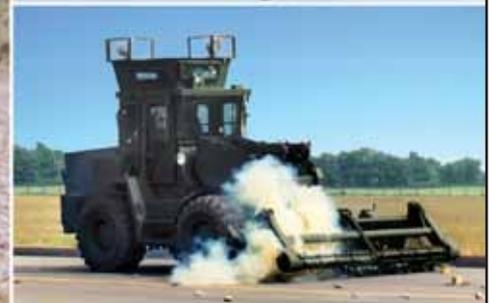
Das System MiL wurde mit bewährter Ahlmann Technologie für die unterschiedlichsten Einsätze entwickelt. Der vielseitige Schwenklader kann laden, stapeln, baggern und eignet sich als Träger für hydraulische Anbaugeräte. Spezielle Ausstattungen und geschützte Ausführungen ermöglichen individuelle Einsätze.
