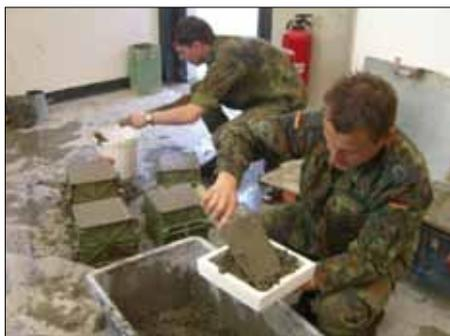
Herstellen von Frischbeton-Probewürfeln im Lehrfach Baustofftechnologie
