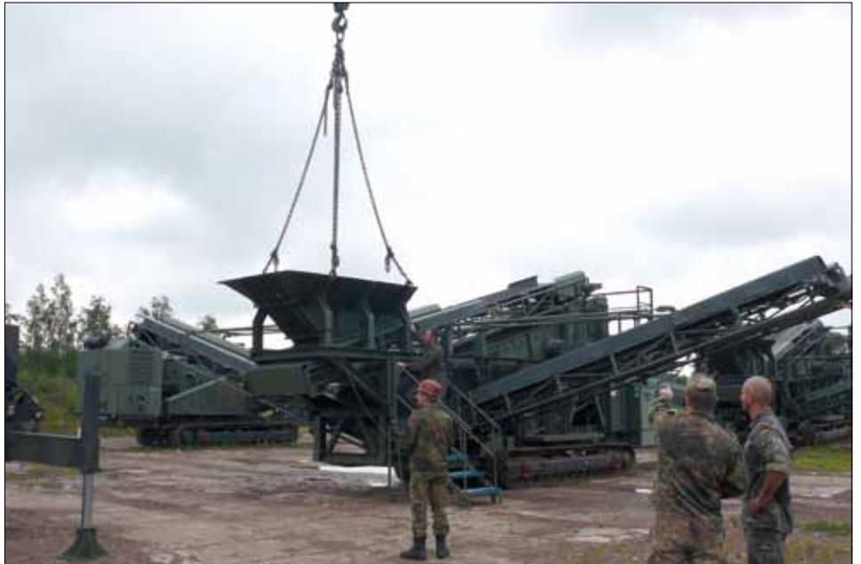
Zerlegen der SM1340T in Ordruf für die Bedarfsinstandsetzung
