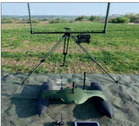
SONOBOT 5 Bw mit Fernbedienung, Tablet u. Landstation
