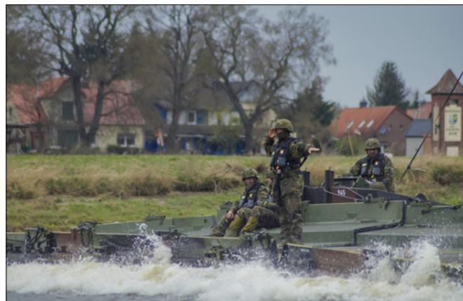
Hochkonzentriert müssen die Fährenführer die einzelnen M-Boote mit Handzeichen führen, um die Fähre durch die Strömung der Elbe zu gieren.
