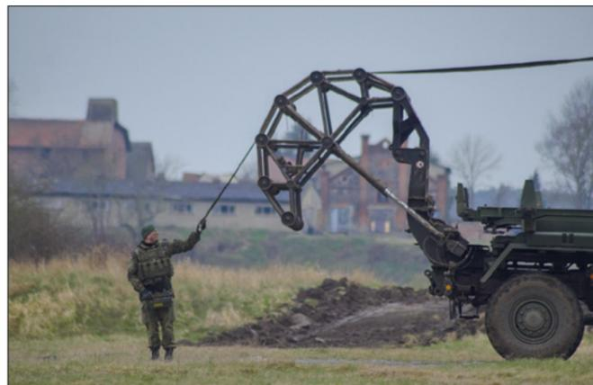
Pioniermaschinenzug mit Faltschiffgerät: schnellstmögliches Schaffen einer 50 Meter langen Straße aus Sechseckplatten für Rad- und Kettenfahrzeuge.
