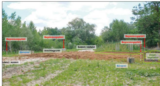
Die Befahrbarkeit wird über die Bewässerung bzw. durch das eingebaute Material gesteuert und reicht von „uneingeschränkt befahrbar“ bis hin zu „nicht befahrbar“.
