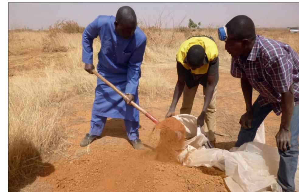
Nigrische Probenahme für die Laborversuche (Kornverteilung, etc.)
