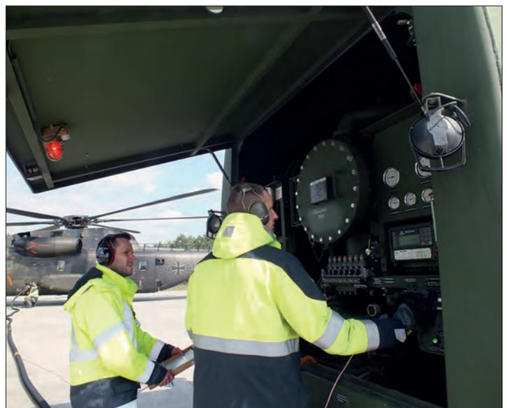
„Heißdruckbetankung“ mit Flugfeldtankwagen an CH-53
