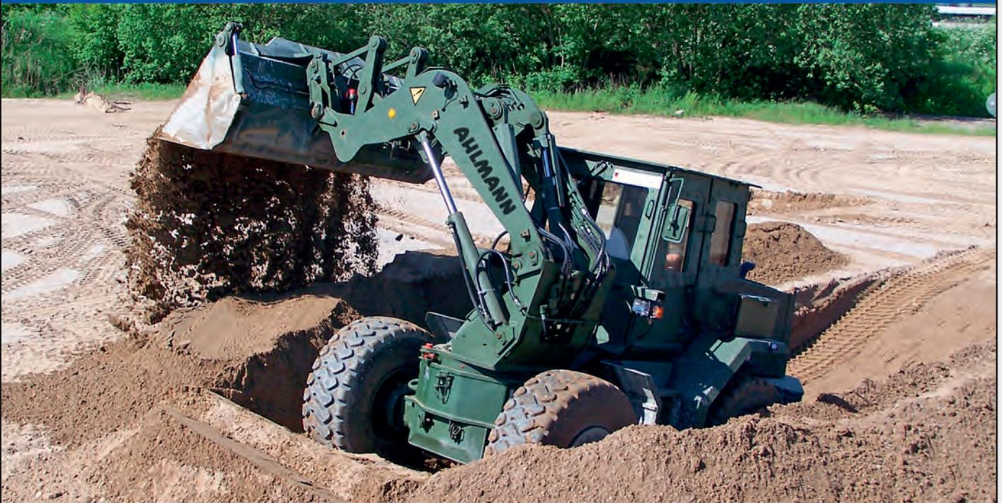
Das **System MiL** wurde mit bewährter Ahlmann Technologie für die unterschiedlichsten Einsätze entwickelt. Der vielseitige Schwenklader kann laden, stapeln, baggern und eignet sich als Träger für hydraulische Anbaugeräte. Spezielle Ausstattungen und geschützte Ausführungen ermöglichen individuelle Einsätze.
