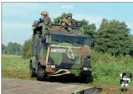
ESK Mungo mit Teilen einer Luftlandepioniergruppe setzten mit Folgeauftrag über die errichtete „Festbrücke, kurz“
