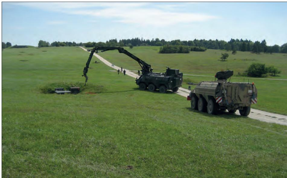
Der TPz Fuchs 1A8 A13 Kampfmittelaufklärung und Identifizierung (KAI), wurde zur Verstärkung des schweren Kampfmittelabwehr Zuges (sKpfmAbwZg) entwickelt, um eine Gefährdung von Kampfmittelabwehrkräften in der Suchformation zu verringern. Im Zeitraum 19.06. bis 06.09.2017 wurde in Stetten am kalten Markt im Rahmen der technischen und taktischen Einsatzprüfungen der KAI auf „Herz und Nieren“ getestet.
